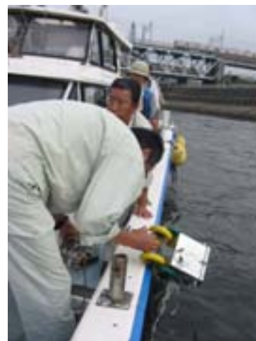
(底質調査のため川の底の泥を採取)
